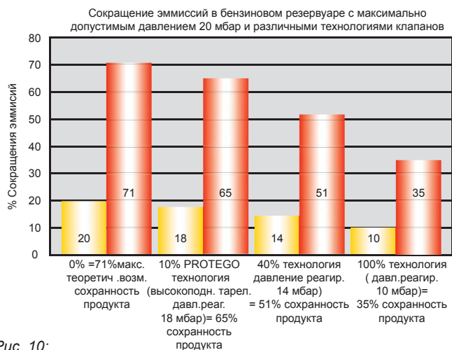
Рис. 10: На рисунке показана возможность экономии продукта на конкретном примере использования клапанов на резервуаре, используемом для хранения бензина. Максимально допустимое давление резервуара - 20 мбар.
